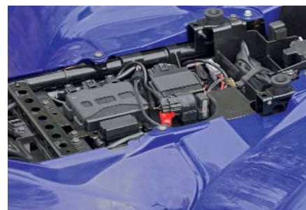
Die hält dicht: Elektrik vorbildlich vor Feuchtigkeit geschützt.
