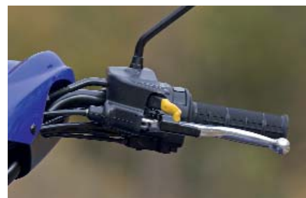
Funktionstüchtig: Die Klinke für die Differentialsperre ist gut einsetzbar und nicht elektronisch.
