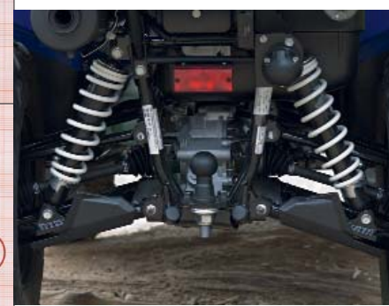
Besser ist das: Einzelradaufhängung beim Update erhöht die Geländetauglichkeit erheblich.
